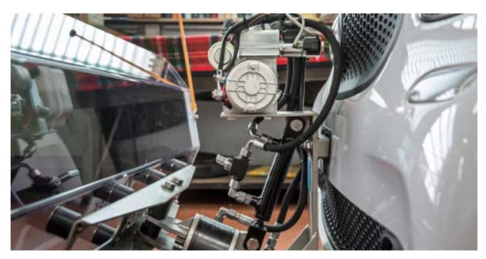
Schnee, Eis, Streusalz und eisige Temperaturen: Die Anforderungen an die verwendeten Werkstoffe sind hoch. Rontex setzt daher auf hochwertige Komponenten aus stabilem, verwindungssteifem und rostfreiem Edelstahl der Güte V4A. Auch die Schlaucharmaturen sind mit ihrer Zink-Nickel-Beschichtung ideal vor Rotrost geschützt.
