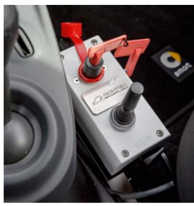
Mittels eines Joysticks kann der Fahrer den einscharigen Schneepflug bequem vom Cockpit aus stufenlos steuern.
